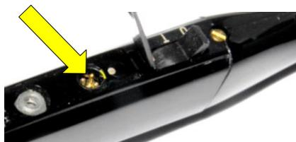
Die Abdeckung dient als Staub und Feuchtigkeitsschutz und muss nach dem Anpassen wieder geschlossen werden. Details entnehmen Sie bitte aus der Gebrauchsanweisung des Gerätes.
