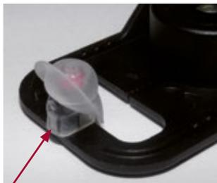
*Gehen Sie sicher, dass das Ohrpasstück komplett auf dem Montagewerkzeug aufgesteckt ist!*
