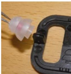
*Das Ohrpasstück über die Aufnahme des Montagewerkzeuges stecken.*
