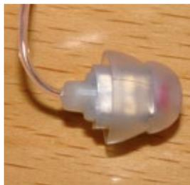
*Einsetzen des High Power Hörers in das geöffnete Ohrpasstück.*
