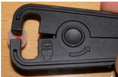
*Ohrpasstück durch Zusammendrücken des Montagewerkzeuges öffnen.*
