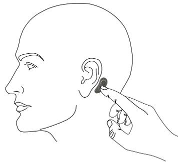
6. Danach wird das Hörsystem einfach mit der Ankopplung auf den Klebeadapter aufgeschnappt.
